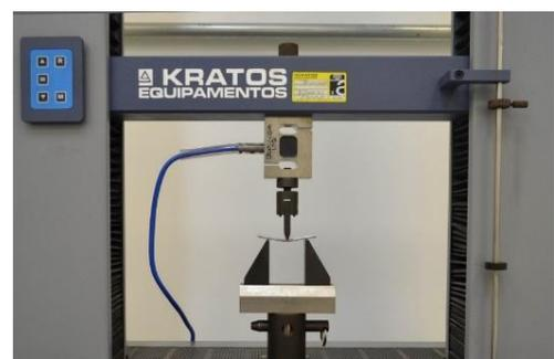
**Figura 3** – Teste de flexão em máquina Kratos.
